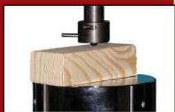
تست سختی سنگی "جانکا" آزمایشی است برای بررسی مقاومت چوب در برابر فرسایش و فشار . در این تست : میزان نیروی که برای وارد کردن یک گلوله ی فولادی ۱۱.۲۸ میلی متری تا نیمه در بافت چوب لازم است : اندازه گیری می شود .
